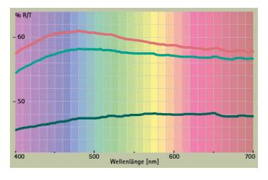
Der **Spektral-Plot** gibt den Reflexionsgrad von Chromschichten wieder. Anhand dieses Diagramms wird deutlich, dass die Chromschichten aus den Bädern SLOTOCHROM DR 1140 und SLOTOCHROM DC 150 sehr ähnlich sind. Hingegen erscheint die abgeschiedene Schicht des Glanzchrombades SLOTCHROM 50 (Chloridbasis) deutlich dunkler.
