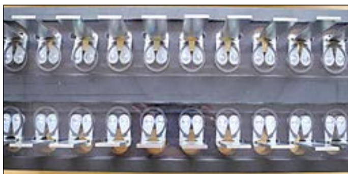
Abb. 11: Verwendeter Prüfstand für die Verspannversuche an C-Ring-Proben
