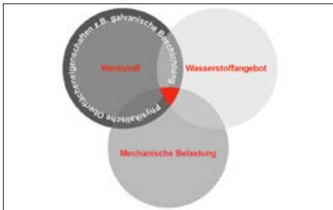
Abb. 1: Ursachen für wasserstoffbedingte Schädigungen unter Berücksichtigung zum Beispiel der galvanischen Beschichtung
