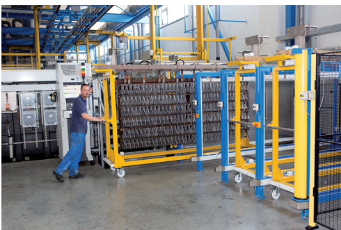
Abb. 3: Beladebuchten mit Sicherheitslichtvorhang
