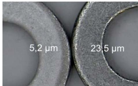
Abb. 1: Unterschiedliche Optik der Oberfläche und unterschiedliche Schichtdicke
