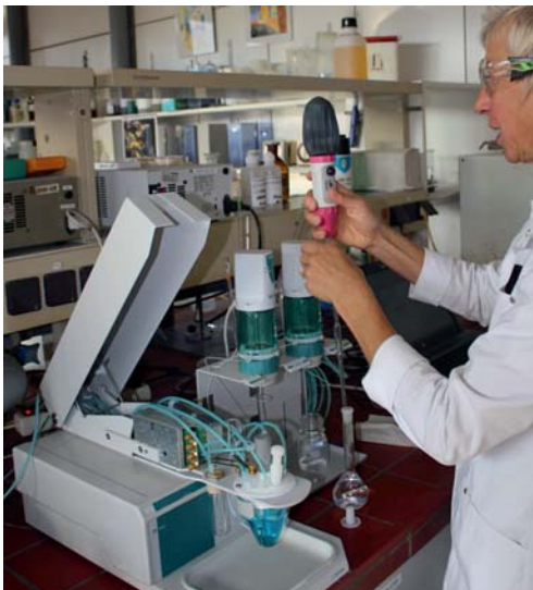
Abb. 3: Bestimmung organischer Additive in einem Kupferbad mittels CVS
